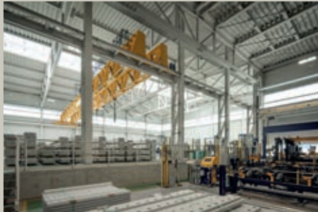
↑ Der Hallenkran mit 25 t Traglast
